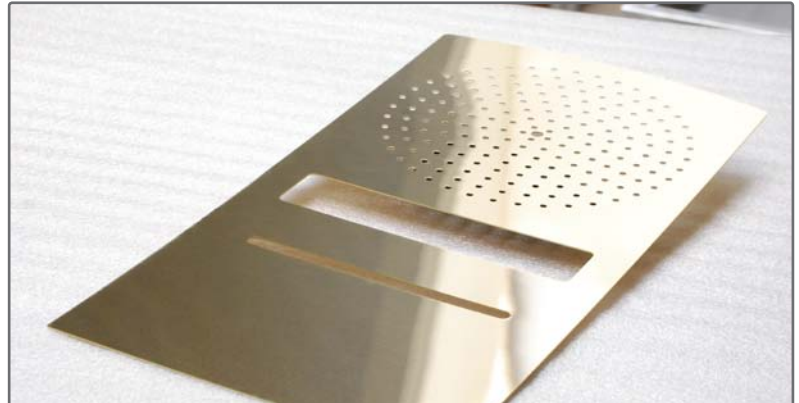
Messingplatte: bei BUT gestanzt und lasergeschnitten
